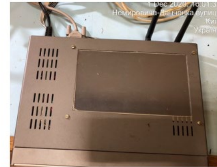
Центральний модуль ПТК: а) зі знятою верхньою кришкою; б) з сенсорним екраном
